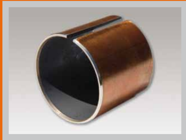
GEROLLTES VERBUNDGLEITLAGER, STAHL/GRAPHITBRONZE, WARTUNGSFREI
